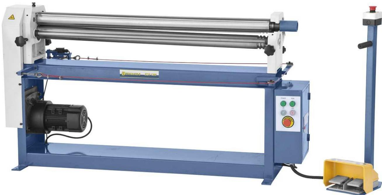
Motorisch betriebene Rundbiegemaschine mit asymmetrischer Walzenanordnung für Profiheimwerker, Werkstätten und Handwerksbetriebe; Asymmetrische Walzenanordnung zum bequemen Vorbiegen; Zum Konischrunden wird die Hinterwalze schräggestellt; Biegewalzen aus hochwertigem Stahl; Ausschwenkbare Oberwalze zur leichten Entnahme des fertigen Werkstückes; Unter- und Hinterwalze serienmäßig mit Drahteinlegerille ausgestattet. Mit Untergestell.
