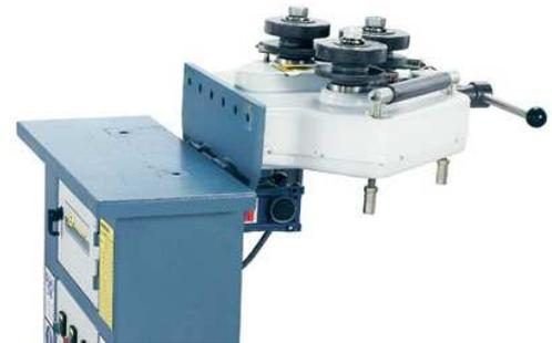
Horizontal und vertikal einsetzbar; 2 angetriebene Walzen; Gehärtete und geschliffene Wellen aus Spezialstahl; mm-Skala zur Einstellung der Oberwalze; Fußpedal im Lieferumfang enthalten; Erweiterter Einsatzbereich durch umfangreiches Sonderzubehör.
