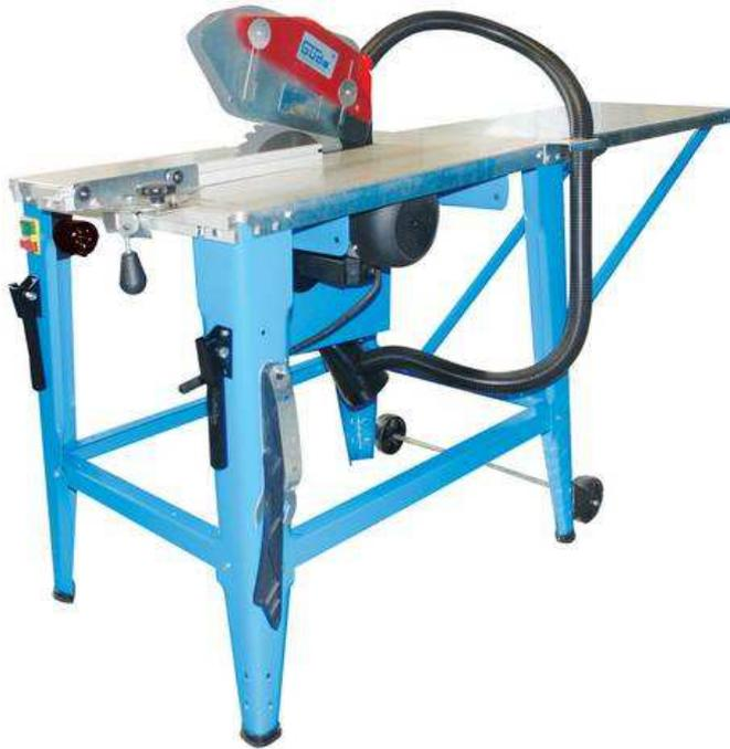
Verzinkter Tisch mit umlaufend profilierten Rundumstreben für beste Standfestigkeit, Längs- und Gehrungsanschlag, Anschluss für Späne Absauganlage, Sägeblatthöhenverstellung durch Kurbelantrieb.
