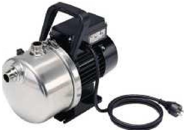
Grundfos Gartenpumpen JP- sind selbstansaugende, horizontale, einstufige Kreiselpumpe mit eingebautem Ejektor. Der Kurzschlußläufer- Motor und der Einsatz einer Gleitringwellenabdichtung machen das Aggregat wartungsfrei und störungsunempfindlich. Lange Lebensdauer durch den Einsatz Edelstahl bei allen hochbeanspruchten Teilen, wie Laufrad und Gehäuse. frei von Störungen durch verschleißarme Gleitringdichtung und robusten Kurzschlussmotor mit integriertem Motorschutz.
