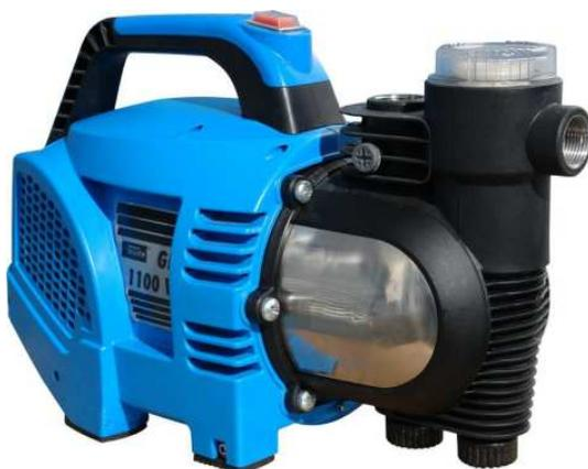
Pumpengehäuse aus schlagfestem Kunststoff; Mechanische Dichtung; Wasserablassschraube; Laufrad aus Noryl; Ergonomischer Tragegriff; Ein-/Ausschalter; Thermoschutz und Motorschutzschalter; Metall Gewindeeinsätze; Integrierter Wasserfilter. Zur Bewässerung des Gartens, zum Betrieb von max. einem Beregner oder zu Entleerung von Teichen und Becken
