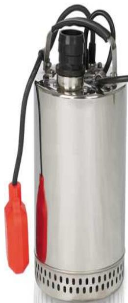
Einstufige Freistrom-Tauchpumpe mit Gehäuse, Welle und Laufrad aus rostfreiem Edelstahl. Der Motor ist hermetisch gekapselt. Die Abdichtung vom Motor zum Pumpenraum erfolgt durch eine Kombination von Gleitring- und Radialwellen- Dichtung mit dazwischen liegender **Ölkammer**. Der Motor wird durch gefördertes Wasser gekühlt und mit Thermoschalter vor Überhitzung geschützt.
