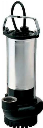
Druckgehäuse und obere Halterung aus Grauguß; Laufrad aus Messing; Filter aus rigidem Kunststoff; Motorgehäuse, Welle und Tragegriff aus Edelstahl. Kondensator-Stecker; Asynchron-Motor 2-polig für Dauerbetrieb geeignet.
