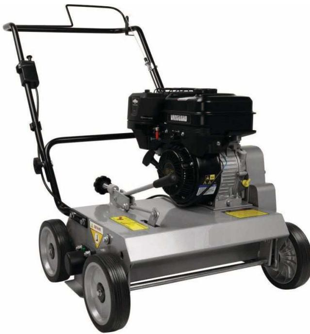
Robuster Vertikutierer mit Stahlgehäuse und kugelgelagerten Rädern mit Stahlfelge. Die Arbeitstiefe lässt sich stufenlos im Bereich regulieren. 28 Pendelschlagmesser in zwei Reihen. Der abklappbare Holm erleichtert Transport. Für professionellen Einsatz geeignet.
