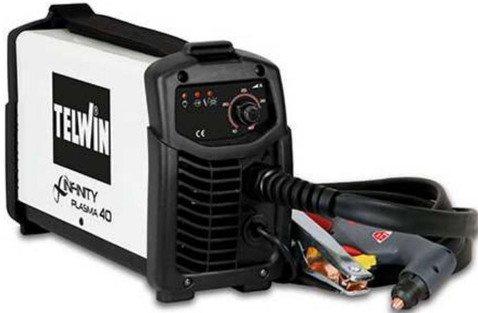
Invertersystem für das Druckluft-Plasmaschneiden mit Kontaktzündung des Pilotlichtbogens. Zum schnellen, verformungsfreien Schneiden aller leitenden Werkstoffe wie Stahl, Edelstahl, Aluminium, Kupfer, Messing, etc. leicht und kompakt; Anzeigen für Brennerspannung und Schutzeinrichtungen; automatische Brennerkühlung; Signali für Verbrauchsmaterialwechsel; Thermostat, Überspannung, Unterspannung, Überlastung.
