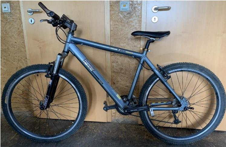
Schaltung/ Schaltwerk: 27- Gang Shimano; Beleuchtung: ohne Lichtenanlage; Diamant- Rahmen; Ahead- Vorbausystem; Lenkerbügel mit Bar Ends; Systemgespeicherte Laufräder mit Alu- Hohlkammerfelgen; Rock-Schox- Frontfederung 160mm.
