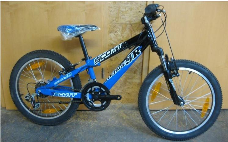
Schaltung/ Schaltwerk: 21- Gang Shimano; Beleuchtung: ohne Lichtenanlage; Diamant- Rahmen; Ahead- Vorbausystem; Lenkerbügel; Systemgespeicherte Laufräder mit Alu- Hohlkammerfelgen; Front-Federgabel
