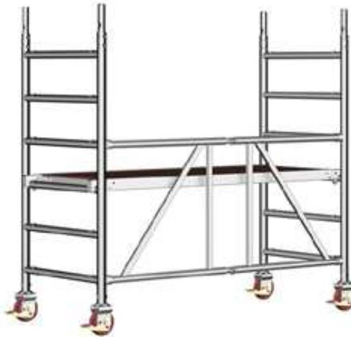
Das ZiFa Gerüst ist praktisch ein "Fertiggerüst" für Arbeiten in geringen Höhen: flach zusammengeklappt lagern und transportieren - auseinanderziehen, Boden einlegen - fertig. Grundeinheit kann aufgebaut und vollbepackt durch jede Zimmertür gefahren werden. Maße der Arbeitsbühne: 0,75 x 1,80 m Zulässige Verkehrslast: 2 kN / m<sup>2</sup> (Gerüstgruppe 3) Maximale Arbeitshöhe: 7,76m-ab 623 mit Fahrbaaken - \* **Mindestanforderungen DIN EN1004-2021**
