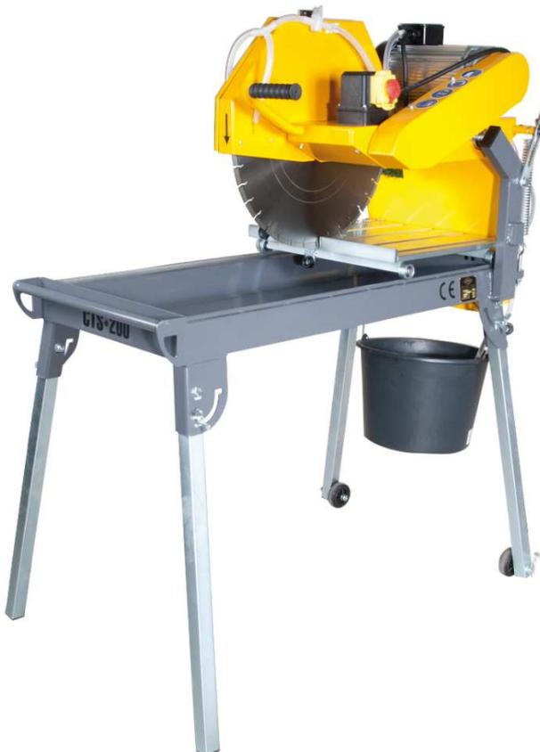
Universelle Steintrennmaschine für Beton, Klinker, Ziegel, Naturstein mit klappbarem Untergestell. Aufnahme von Trennscheiben bis 500mm Durchmesser für Schnitttiefen bis 200mm; leistungsstarker Motor mit 400V; stufenlos verstellbarer, arretierbarer Pendelschneidarm; leichtgängiger Rolltisch mit Meß-Skala und verstellbarem Seitenanschlag; klappbare Füße, Tragegriffe auf beiden Seiten; Kranösen und Laufrollen; Kühlwasserversorgung durch elektrische Pumpe.
