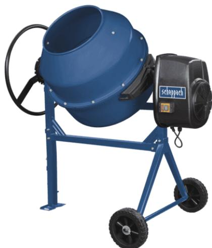
Geschweißter Trommelboden für mehr Stabilität; 140ltr Fassungsvermögen der Trommel; Fahrvorrichtung für einen einfachen Transport; Große Trommelöffnung für leichtes Entleeren; Das Labyrinth-Gehäuse schützt vor Spritzwasser und garantiert dank des Doppellüfters aber dennoch eine gute Motorkühlung; Langlebig und robust; Zahnräder aus Guss; Einstellbare Federspannung; Einfache Wartung.
