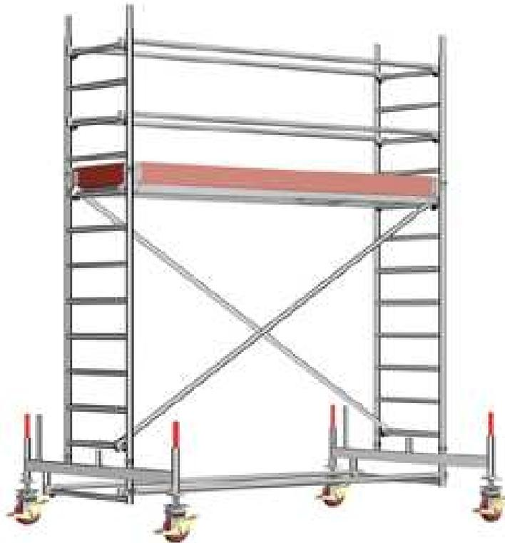
Für Arbeiten an der Wand und an der Decke, an Maschinen, in technischen Anlagen, Betriebs- und Lagerhallen, Innen und außen. Arbeitsbühne: 0,75 x 2,85 m Zulässige Verkehrslast: 2 kN / m<sup>2</sup> (Gerüstgruppe 3) Maximale Arbeitshöhe: 13,38 m - \* **Mindestanforderungen DIN EN1004-2021**
