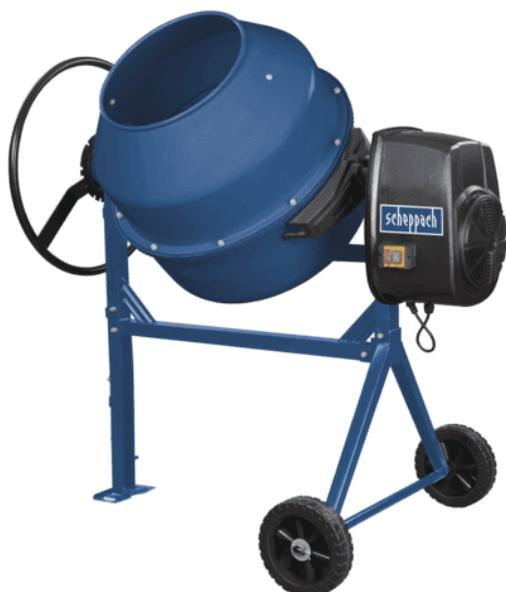
Geschweißter Trommelboden für mehr Stabilität; 180ltr Fassungsvermögen der Trommel; Fahrvorrichtung für einen einfachen Transport; Große Trommelöffnung für leichtes Entleeren; Das Labyrinth-Gehäuse schützt vor Spritzwasser und garantiert dank des Doppellüfters aber dennoch eine gute Motorkühlung; Langlebig und robust; Zahnräder aus Guss; Einstellbare Federspannung; Einfache Wartung.
