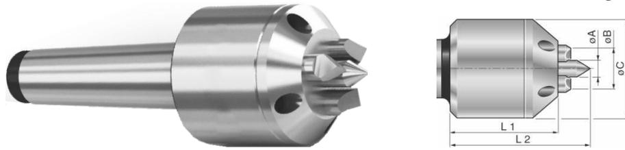
Stirnseitenmitnehmer Form "A" zum rationellen Drehen von Werkstücken auf ganzer Länge ohne Umspannen sehr genau. "A" Spannkreis-Ø 17-25mm.
