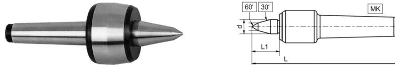
Mitlaufende Drehbankspitze mit verlängerter Spitze 30°/60° Der Außenkegel ist präzisionsgeschliffen, dadurch ist eine hohe Rundlaufgenauigkeit gewährleistet. Spezielle Wälzlager garantieren eine hohe Belastbarkeit und einen wartungsfreien Einsatz.
