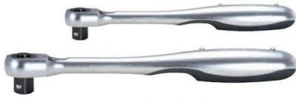
**919.1400+919.1200** Vierkantantrieb nach DIN3120/ISO1174 mit Kugelarretierung; umschaltbar; fein verzahnter 72-Zahn Ratschenmechanismus; mit Druckknopf-Schnellösefunktion am Ratschenkopf; mit Aufhängeloch; hochglanz verchromt; Chrom Vanadium; Rückstellwinkel nur 5°; Extrem schlanke Köpfe; Sicherheitsratsche mit Einsatzschnellösefunktion und Kugelarretierung; Ergonomisch gestalteter Handgriff mit Gummieinlage; Rutschfest.
