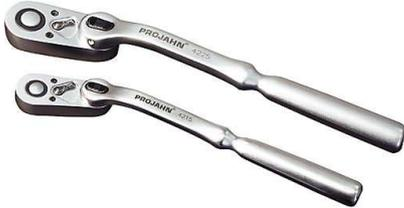
Vierkantantrieb nach DIN3120/ISO1174 mit Kugelarretierung; umschaltbar; fein verzahnter 72-Zahn Ratschenmechanismus; mit Druckknopf-Schnellösefunktion am Ratschenkopf; Chrom Vanadium; Rückstellwinkel nur 5°; mit Rotationskopf 360° verstellbar.
