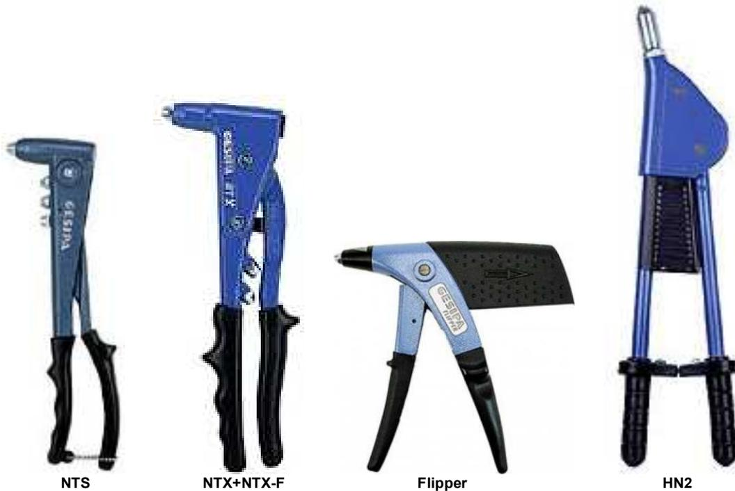
**NTS:** Zangengehäuse: hochwertiger Aluminiumdruckguß; Zangenschenkel: Stahl, geschmiedet; Schmaler Zangenkopf für schwer zugängliche Nietstellen; Öffnungsfeder für selbsttätigen Dornauswurf; Handgereehte Stulpgriffe.
