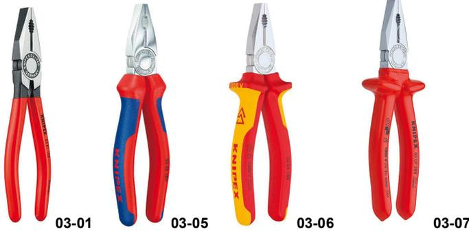
Greifzonen für Flach- und Rundmaterial für vielseitigen Einsatz; mit Schneiden für weichen und harten Draht; lange Schneiden für dickere Kabel; Schneiden zusätzlich induktiv gehärtet (ca.60HRC); Spezial-Werkzeugstahl, geschmiedet, ölgehärtet.
