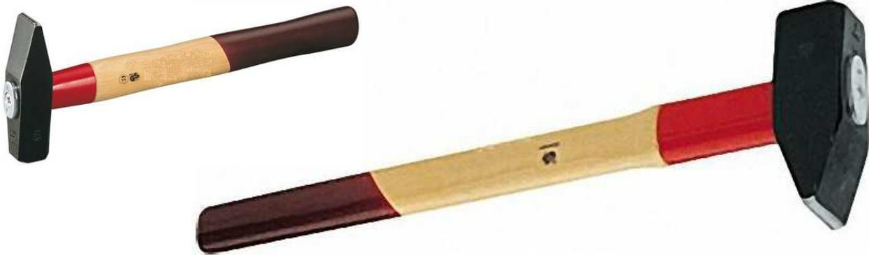
Geschmiedeter Hammerkopf DIN1041; Doppelt geschweißter Hickorstiel DIN5111, mit zusätzlicher langer, gehärteter Stahl-Stielschutzhülse; Durch Ringkeil, Sicherungsplatte und Holzschraube werden Hammerkopf und Holzstiel zu einer Einheit; Patentierte Stielbefestigung, hohe Sicherheit, lange Lebensdauer.
