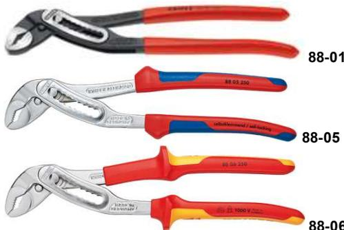
durchgestecktes Gelenk: hohe Stabilität durch doppelte Führung; selbstklemmend an Rohren und Muttern: kein Abrutschen am Werkstück, kraftsparendes Arbeiten; Klemmschutz verhindert Quetschverletzungen; günstige Hebelwirkung: optimale Kraftübertragung; Greifflächen mit spezialgehärteten Zähnen, Härte der Zähne ca. 61 HRC; dauerhaft sicheres Greifen durch hohe Verschleißfestigkeit; Chrom-Vanadin-Elektrostahl, geschmiedet, ölgehärtet
