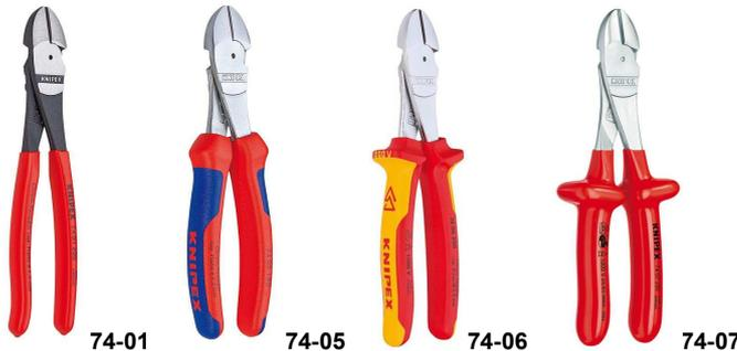
Angeschmiedeter Gelenkchase für härteste, dauerhafte Beanspruchung; optimal für alle Drahtsorten einschließlich Pianodraht; hohe Schneidleistung bei geringem Kraftaufwand durch optimale Abstimmung von Schneidwinkel und Übersetzungsverhältnis; Präzisions-Schneiden zusätzlich induktiv gehärtet (ca.64HRC); Chrom-Vanadin-Hochleistungsstahl, geschmiedet, ölgehärtet. Der 250mm lange Seitenschneider ist geeignet für Cu bis 16mm<sup>2</sup> + Al bis 35mm<sup>2</sup>
