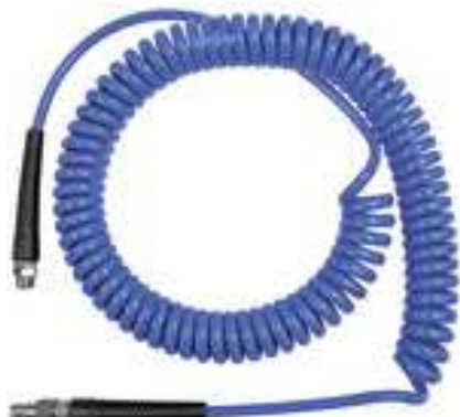
PU-Spiralschlauch mit Verschraubung und Knickschutzfeder, in verstärkter Standardausführung für höhere Drücke. Der äußerst elastische Polyurethan-Schlauch verfügt über eine ähnliche Rückholkraft wie der herkömmliche Polyamid-Spiralschlauch, neigt jedoch weniger zur Schleifenbildung und hat eine deutlich höhere Abriebfestigkeit. Die Gefahr des Verkratzens von lackierten oder empfindlichen Oberflächen ist somit geringer. Der Schlauch ist extrem flexibel und knickfest.
