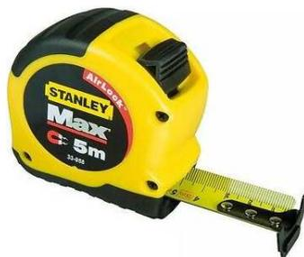
Bandmaß mit AirLock-Feststell-Mechanismus; Magnetischer Endhaken mit patentierter Form; Extra-starkes Band (19 bis 28mm), gebogen; Band vollständig mit Mylar-Schutzschicht überzogen; Gefederter Bandrücklauf; Endhaken dreifach vernietet, verschiebbar für Innen- und Außenmessung; Robustes **Kunststoffgehäuse**, verschraubt und schlagfest, gummiert; Gürtelclip; Höchster Bedienungskomfort und maximale Haltbarkeit; Mit Feststeller und automatischem Rücklauf; Genauigkeitsklasse II.
