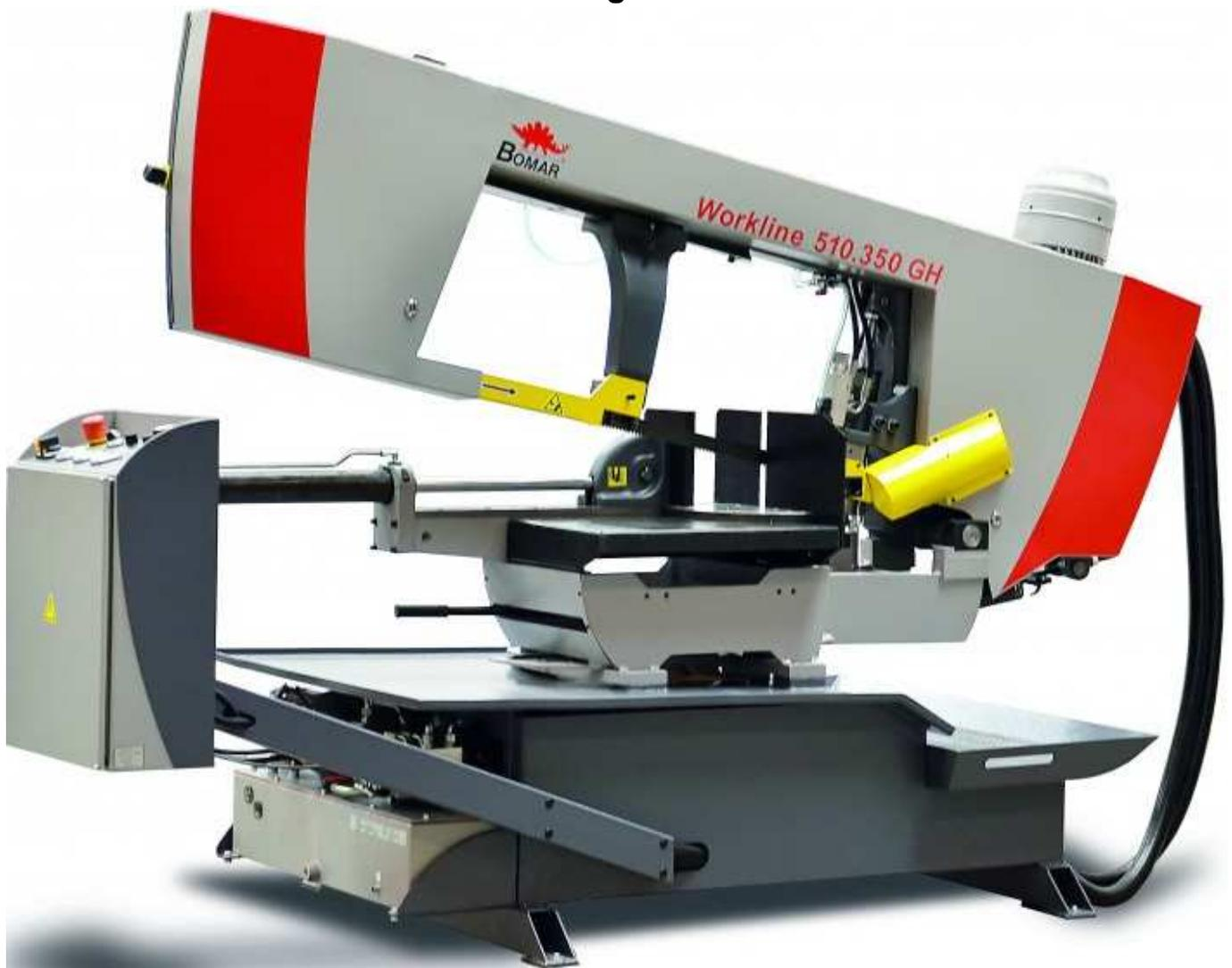
Stufenlose Gehrungsschnitte beidseitig bis 60°; Große, gut lesbare Gehrungsskala direkt an der Vorderseite der Maschine beim Gehrungs- Klemmhebel; Hydraulischer Vollhub-Spannstock in Niederzugausführung; Leicht Verschiebbarer Spannstock für Gehrungsschnitte; Groß dimensioniertes Hydraulikaggregat; Synchron zur Bandgeschwindigkeit angetriebene Spänebürste; Einfache leicht verständliche Bedienoberfläche; Elektronische Sägebandspannungs- und -bruch-Kontrolle.
